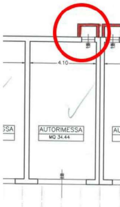
Planimetria DIA in variante n°18021/2006 indicativa e non in scala con indicate in rosso le difformità rilevate
